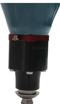
4. Atornille la bomba en el encaje con los tornillos M6 x 60 mm.
